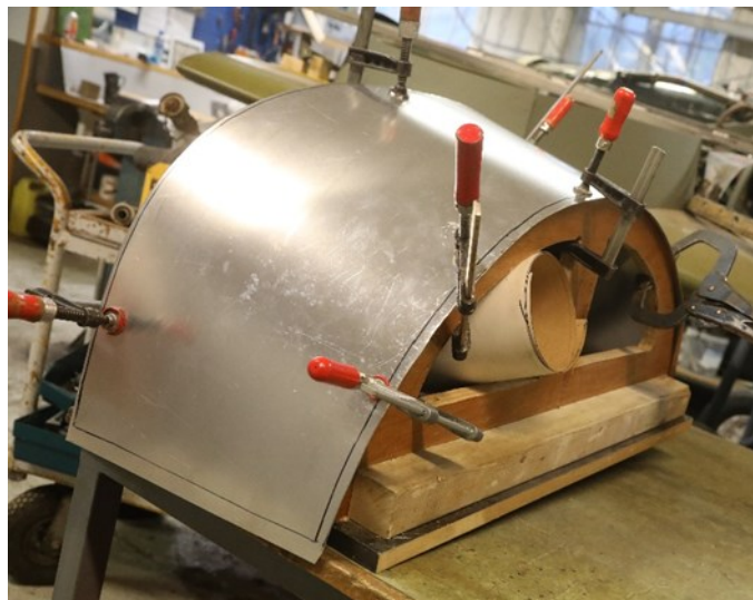
Ingvar har laget en mal som utgangspunkt for å få de nye motordekslene korrekte.
