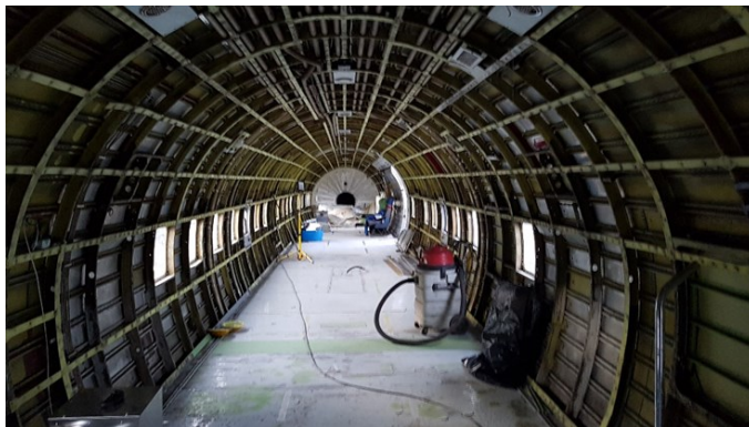
Kabinen etter at lineren er fjernet.
