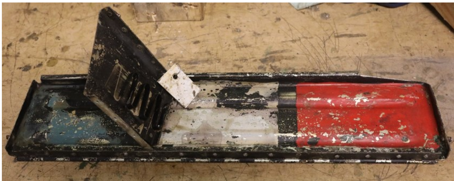
Lokket var i bra stand og kunne brukes uten noe arbeid, men kassen var det lite igjen av, så det ble laget en ny.
