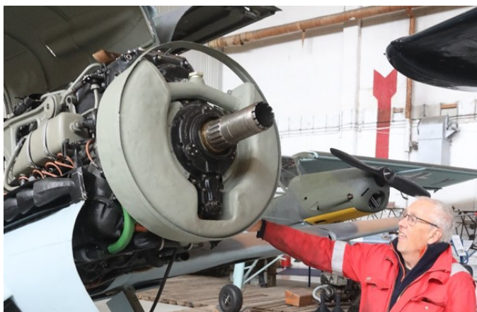
Ingvar Rasmussen viser at oljetanken ligger som en smultring mellom motoren og propellen. Ingvar har tett på seg jobben med nye motordeksler.
