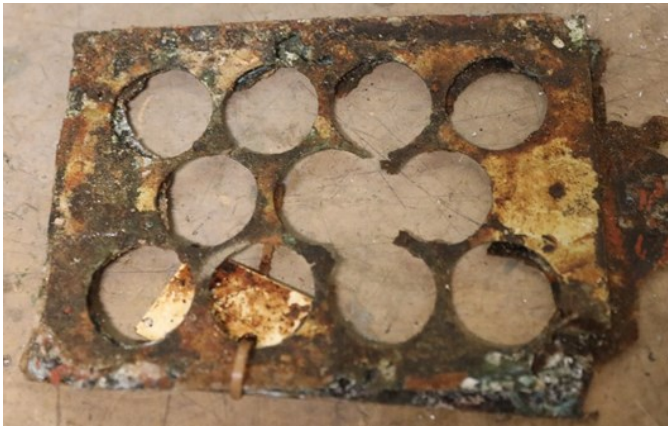
Det var tre utvendige beslag - et av dem var bevart og kunne brukes som mal for å lage nye.
