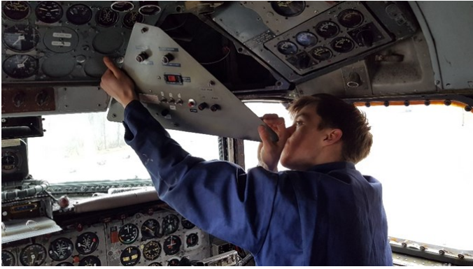
De gamle panelene tas ut.
