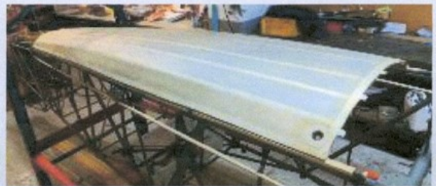
Nachgebaute Abdeckung des hinteren Rumpfes
