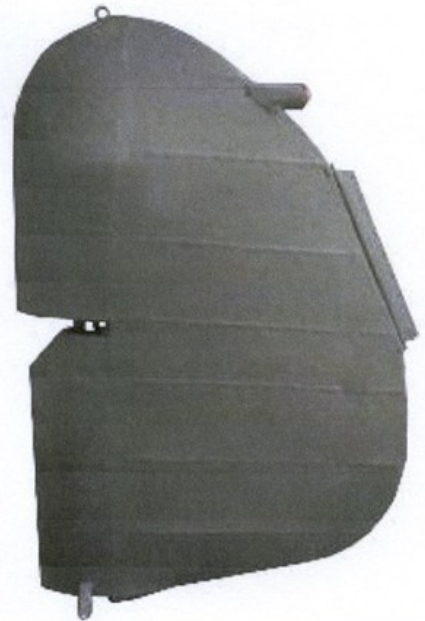
Auch das Seitenruder der Ar 66 C ist fertig, aber den Stahlrohrrahmen zu verkleiden dauert noch
