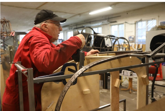
Siegfried og Harald er allerede i gang med arbeidet på Caproni-nesen. Øverst er Siegfried i gang med å sveise sammen rammen og pusse de ferdige sveisene, nederst er Harald i arbeid.
