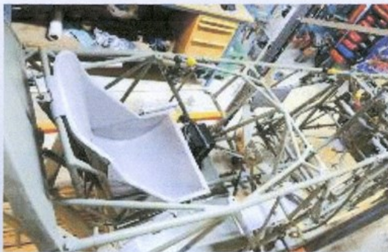
Blick ins hintere Cockpit. Im Fußraum links vor dem Sitz der originalgetreu nachgefertigte Akkumulator
