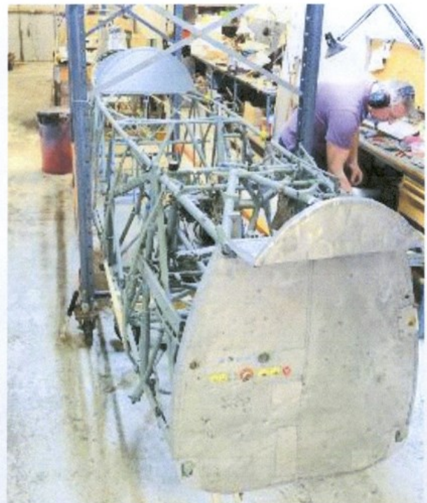
Zelle der W. Nr. 767 im »Ochsengrill« in Stavanger. Der Rahmen verhindert, dass sich der Rumpf während der Arbeiten verwindet
