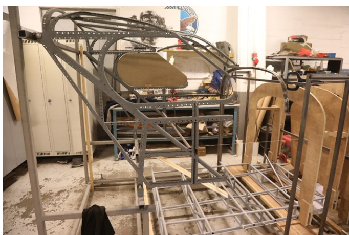
Caproni-nesen slik den fremsto i slutten av 2021. Øverst er de bevarte originale bevarte delene fra Vangsmjøsa, nederst den nylagete gulvrammen.
