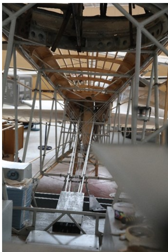
Interiøret i flykroppen sett forfra. De fleste av stagene til rorene er montert inn
