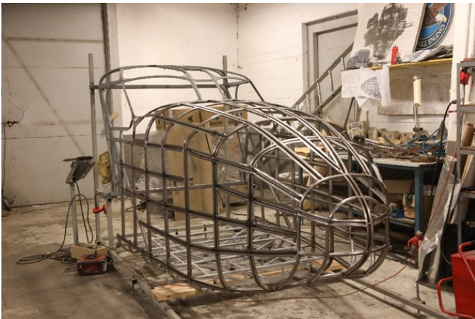
Og her er skelettet til neseseksjonen ferdig i mars.
