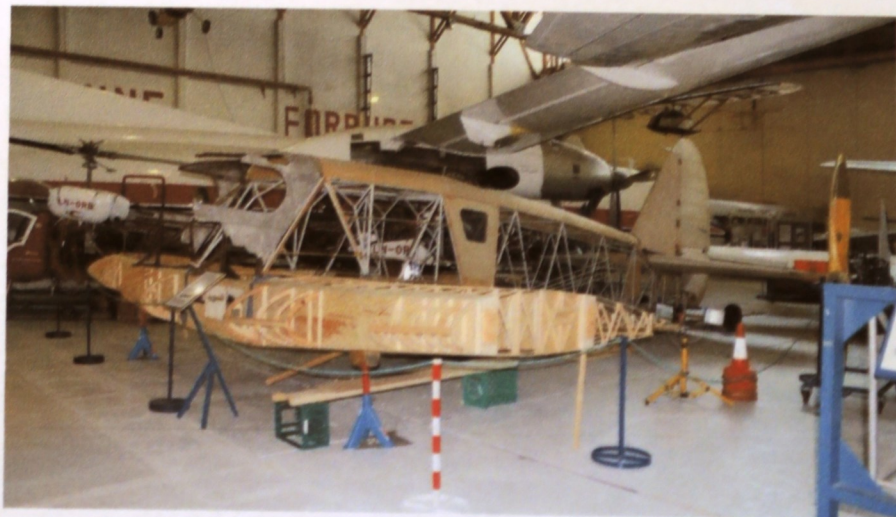
La fusoliera, con i piani di coda e il tronco alare centrale, ricostruiti da zero (Foto: dal web).
