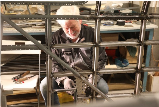
Før arbeidet med å platekle seksjonen kan starte, må det bores hull for naglene som skal feste platene. Her er Roar Henriksen i gang med det arbeidet.
