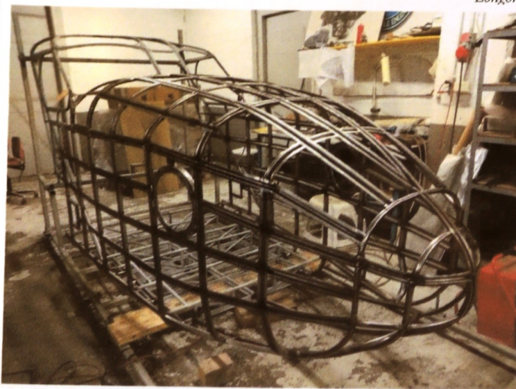
Il traliccio della sezione anteriore di fusoliera. Le parti del "naso", lucide, sono nuove ricostruite, mentre si riconoscono i resti originali provenienti da Rodi, in corrispondenza dell'intelaiatura del parabrezza, di colore grigio (Foto: Rasmus Svihus via Maurizio Longoni).
