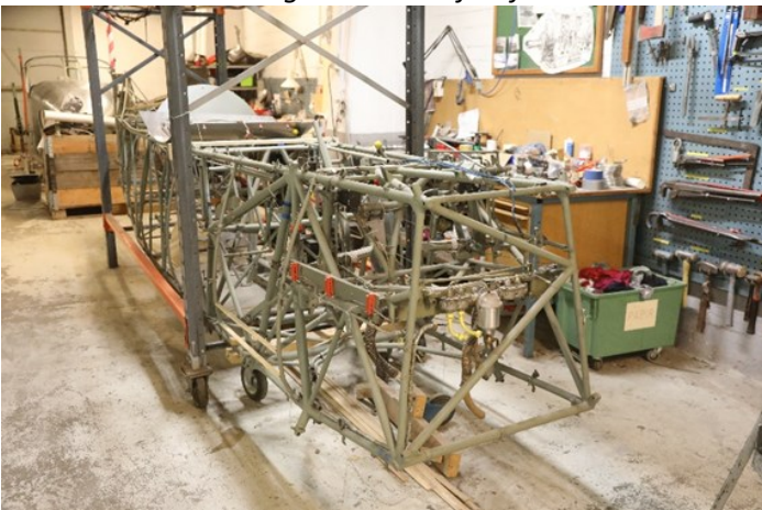
Skroget til flyet som blir bygget opp
