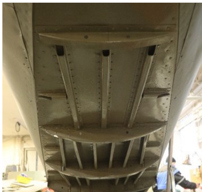
Buken av Ar 96 før platekledning
