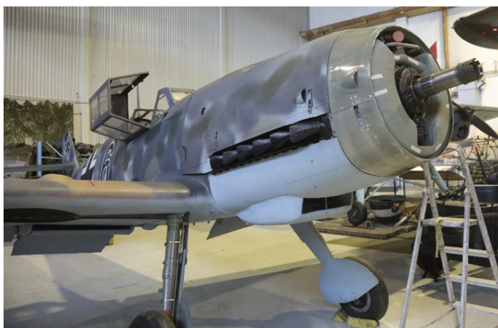
Svart 6 med nye ytterdeksler som passer med en montert oljetank.
