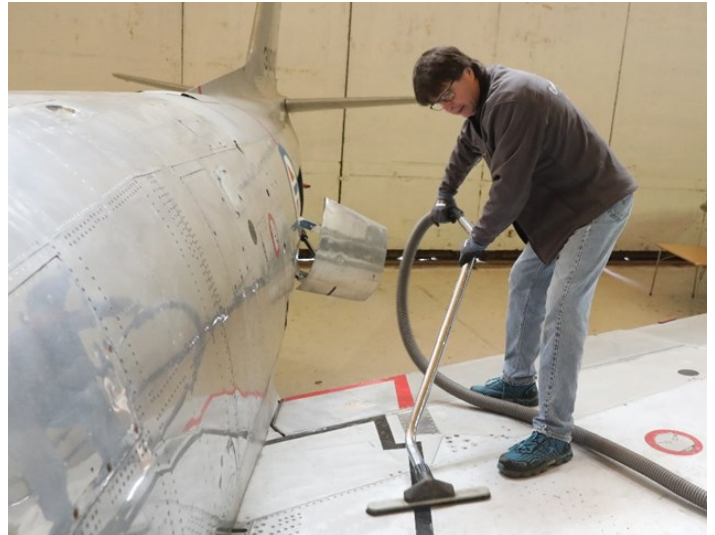
Først blir vinger og overflater støvsuget
