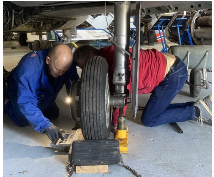
Alle flyene som skal henges opp må veies slik at opphengene kan dimensjoneres korrekt. Her er Kjell Naas og Harald Øverland i gang med å veie en F 86
