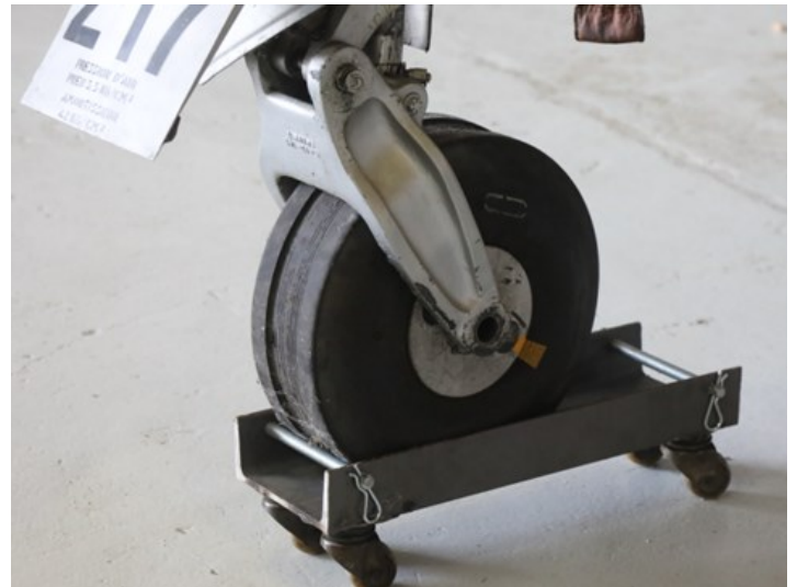
For å kunne manøvrere flyet til den posisjonen det måtte stå i, var det nødvendig å lage denne innretningen som ble plassert under hjulet for lettere å kunne manøvrere flyet
